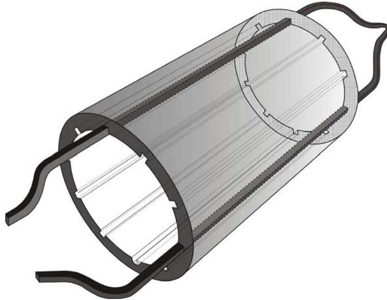
Слика 2.31. Изглед цилиндричног магнетског кола статора са једним навојком који чине два проводника положена у наспрамне жлебове.
