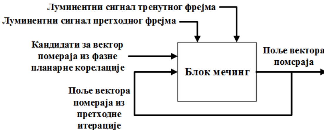
Слика 3-6: Дијаграм улазних и излазних података Блок мечинг модула.
