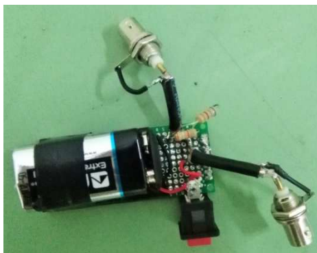
Слика 6.37: Електрично коло за повезивање фотодиоде.
