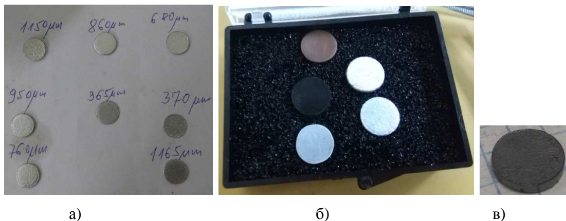
Слика 6.36: Узорци а) од полиамида различитих дебљина, б) пет узорака за упоредна испитивања и в) узорак од графита.
