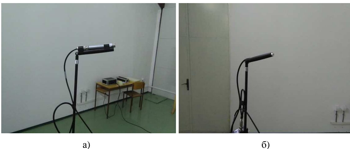
Слика 7.10: а) Референтни и б) испитивани микрофон.
