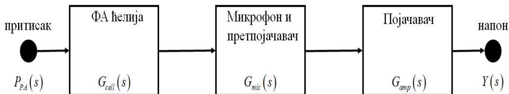
Слика 5.1: Блок-дијаграм ФА мерног система.
