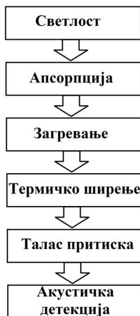
Слика 2.3: Принцип настанка ФА ефекта.
