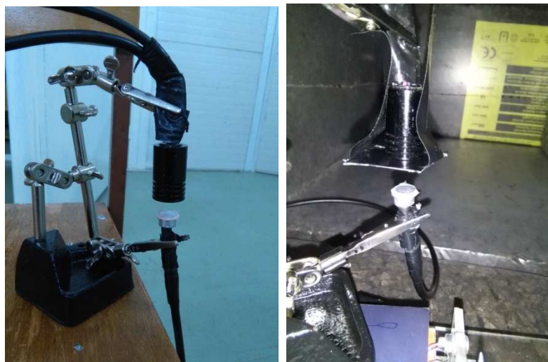
Слика 6.3: а) Сталак са микрофоном и светлосним извором са а) откритим и б) покривеним светлосним извором.
