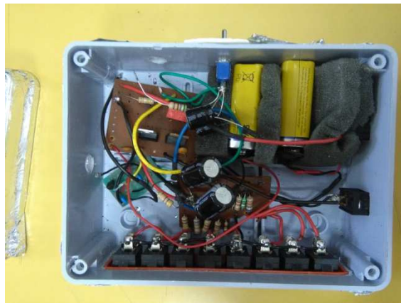
Слика 6.25: Кутија у коју су смештена електрична кола која чине први напонски појачавач.
