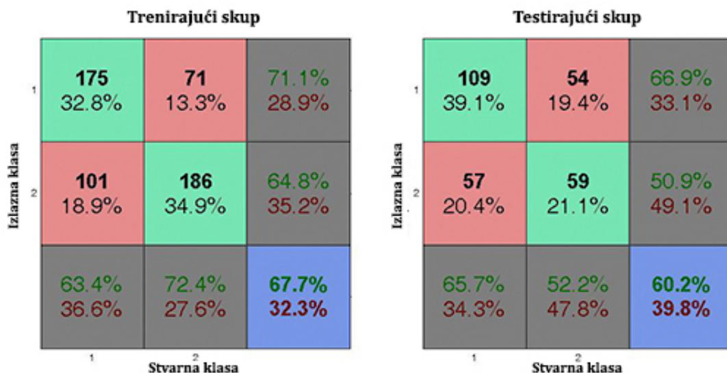
Slika 4.11. Rezultati klasifikacije namere na osnovu trajektorije tokom pripreme za hvat na primeru olovke prikazani u formi konfuzione matrice. Na levom panelu prikazani su rezultati klasifikacije na trenirajućem skupu dok su na desnom prikazani rezultati na testirajućem skupu. (1- lateralni hvat, 2 – hvat prstima)
