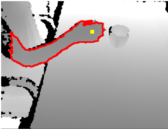
Slika 4.8. Procenjene ivice ruke (crvena boja) i pozicija referentne tačke (žuta boja) dobijeni algoritmom kompjuterske vizije za praćenje pozicije i orijentacije ruke su prikazani u okviru dubinske slike za svaku od slika u snimljenoj sekvenci radi vizuelne provere njihove tačnosti
