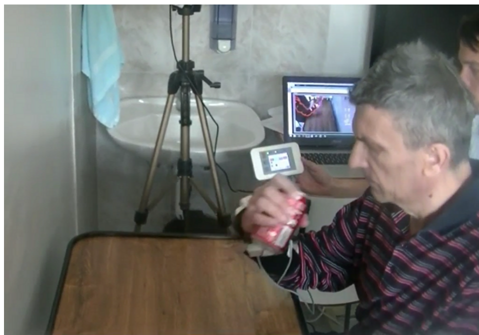
Slika 5.11. Sistem za artifičijelnu percepciju tokom kliničkih testova. Pacijent paretičnom rukom (Subjekat 1) uz pomoć električne stimulacije hvata predmet i prinosi ga ustima, dok sistem artifičijelne percepcije (monitor u pozadini) reguliše šemu stimulacije na osnovu slike sa Kinect kamere
