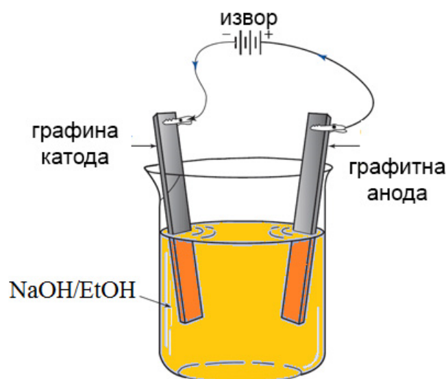
Слика 13. Апаратура за електрохемијску синтезу графитних квантних тачки
