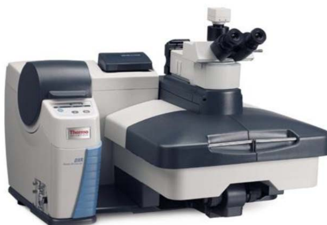
Слика 28. Рамански спектрофотометар DXR Raman Spectroscopy Thermo Scientific коришћен у склопу овог истраживања.
