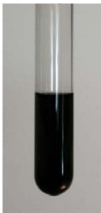
Слика 23. Стабилан колоид графена стабилизован помоћу PVP-40, након ултразвучног третмана.
