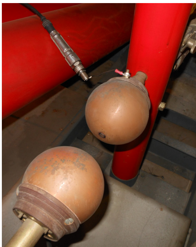
Слика 9.7 – Фотографија начина повезивања свјећице на прво кугласто искриште ударног генератора на коме се врши његово окидање
