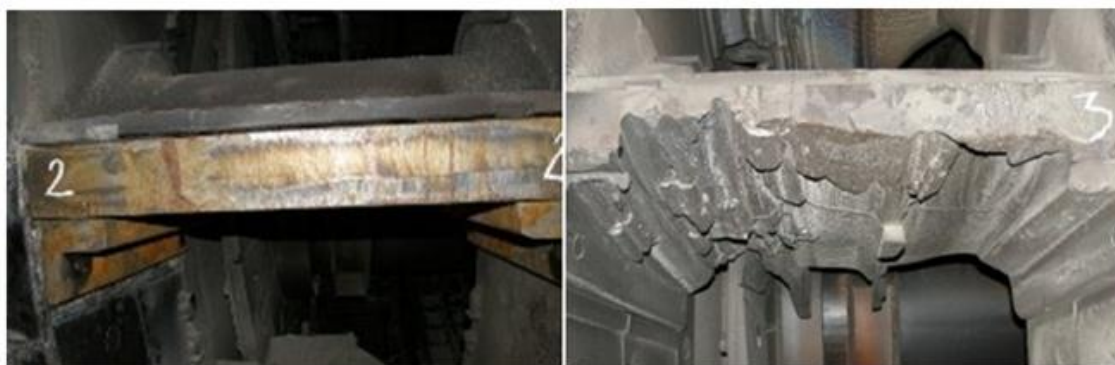
Slika 5.2: Izgled nove (levo) i istrošene (desno) udarne ploče mlina
