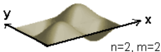
Slika 2.5 Modovi oscilovanja pravougaone membrane
