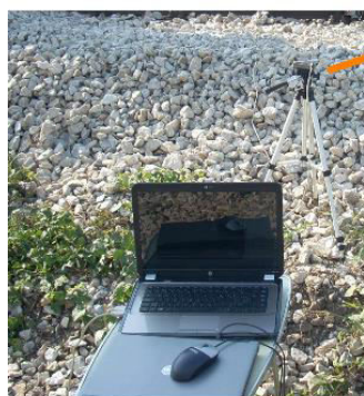
Slika 8.3 Laserski sistem za merenje statičkog ugiba šina
