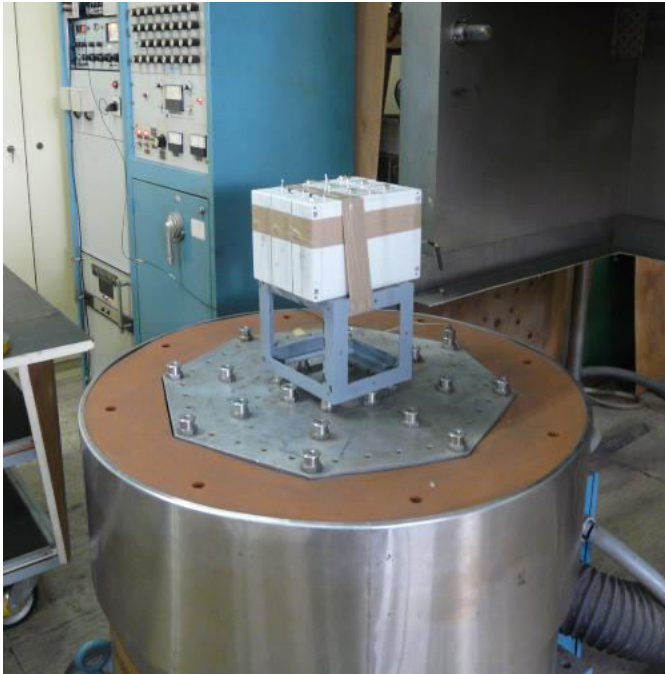
Slika 7.7 Senzorski uređaji na vibracionoj platformi
